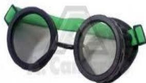
Óculos de segurança, constituídos de duas oculares em formato de concha, unidas por uma ponte composta de uma corrente recoberta com uma capa plástica e tirante elástico para ajuste. As oculares, de 50 mm de diâmetro, possuem anéis de retentores rosqueáveis que permitem a colocação dos filtros de luz de policarbonato verde de tonalidade 5 e das lentes de cobertura de policarbonato incolor.
