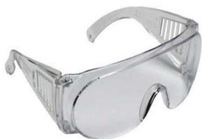
Óculos de segurança constituídos de armação e visor em uma única peça de policarbonato incolor ou verde ou amarelo ou cinza, com borda superior com meia proteção nas bordas e hastes tipo espátula. As hastes tipo espátula são confeccionadas do mesmo material da armação com seis fendas para ventilação e fixas à armação através de pinos plásticos.
